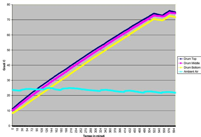
Il requisito fondamentale di tutte le tecnologie di riscaldamento dei fusti consiste nell'incrementare o mantenere la temperatura del contenuto del fusto, la peculiarità di **INDITHERM®** consiste nell'assicurare che l'intero contenuto del fusto venga riscaldato in maniera uniforme e in breve tempo.
